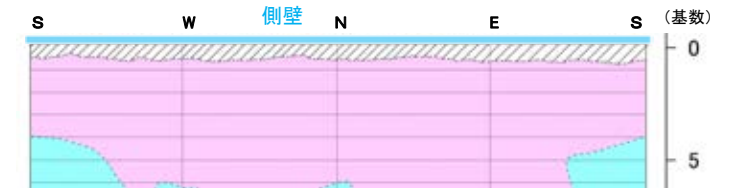
地質展開図(取水路立坑 側壁)
