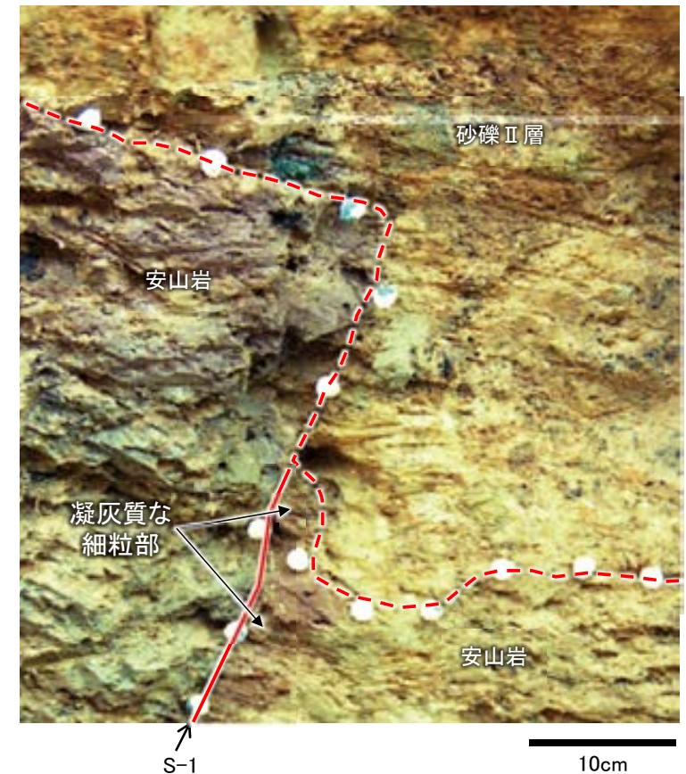
旧Aトレンチ南東壁面 シーム付近拡大写真 (シーム及び岩盤/堆積物境界を加筆)
