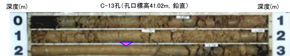
コア写真(C-13孔 深度0~3m) 岩盤(深度2.40m~)の上位に堆積物(シルト)が認められる
