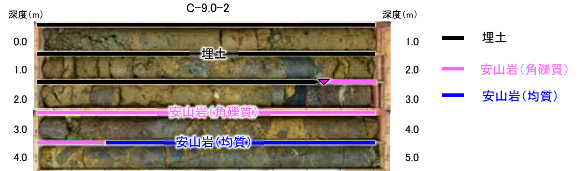
コア写真(深度0~5m) ▼ 埋土と安山岩(角礫質)の境界 (EL19.27m)
