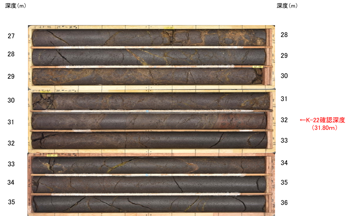
H'-0.9-45孔(掘進長40.00m, 傾斜45°)
