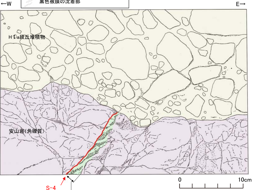
S-4 (主せん断面) 黒色被膜が多く認められる帯状の部分 (固結した破碎部の可能性がある(前頁参照))
