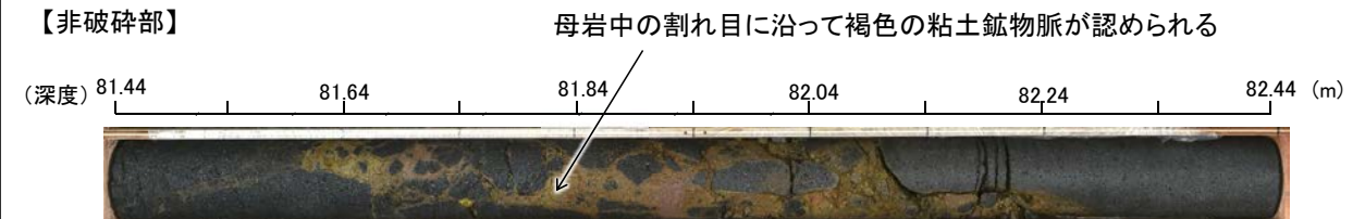
母岩中の割れ目に沿って粘土鉱物脈が認められる事例 (試料R, H-6.5-2孔 深度81.80m付近)
