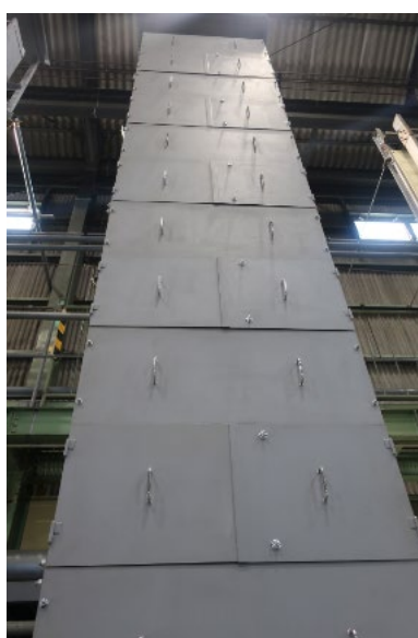
第26図 ソリッドトレイの消火実証試験装置の外観(垂直)
