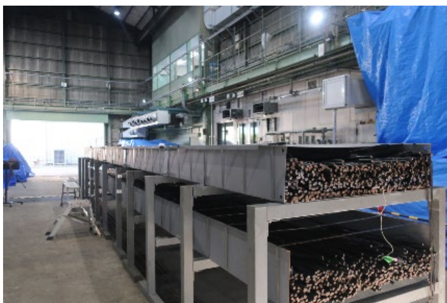
第25図 ソリッドトレイの消火実証試験装置の外観(水平)
