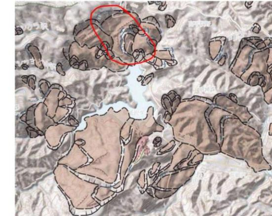
図 5 再判読した荒砥沢ダム周辺の地すべり地形分布図と荒砥沢地すべりの変動範囲（赤線の範囲）
