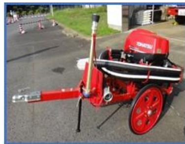
[可搬型消防ポンプ]
