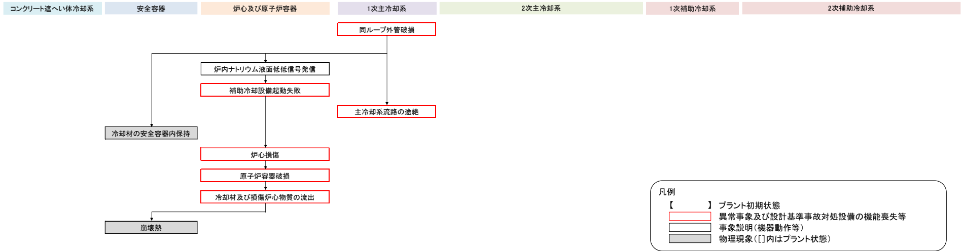
第 2.2.3.1 図 LORL (i) (炉外事象 (外管破損から)) における格納容器破損防止措置の有効性評価に係る事象推移と物理現象
