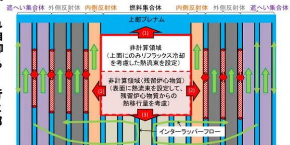
FLUENTによる残留炉心物質周囲の熱移行現象のモデル化概念図
