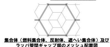
集合体 (燃料集合体、反射体、遮へい集合体) 及びラツバ管間ギャップ部のメッシュ配置図
