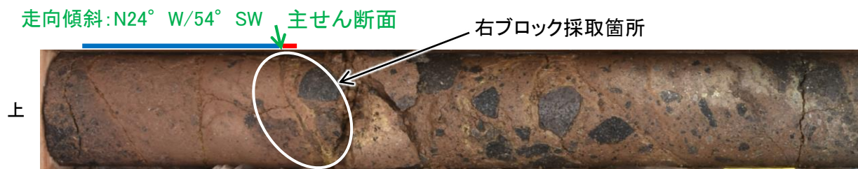
ボーリングコア写真(H-5.4-1E孔)
