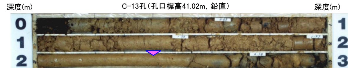
コア写真(C-13孔 深度0~3m) 岩盤(深度2.40m~)の上位に堆積物(シルト)が認められる
