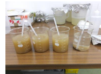
ビーカーを用いた水簸の例
