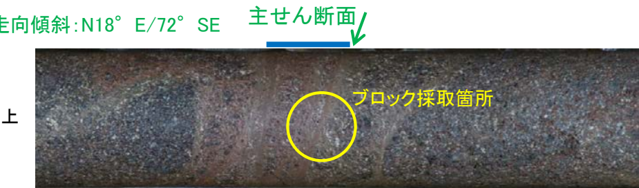
固結した破碎部 ボーリングコア写真 (N-2.3-1孔)
