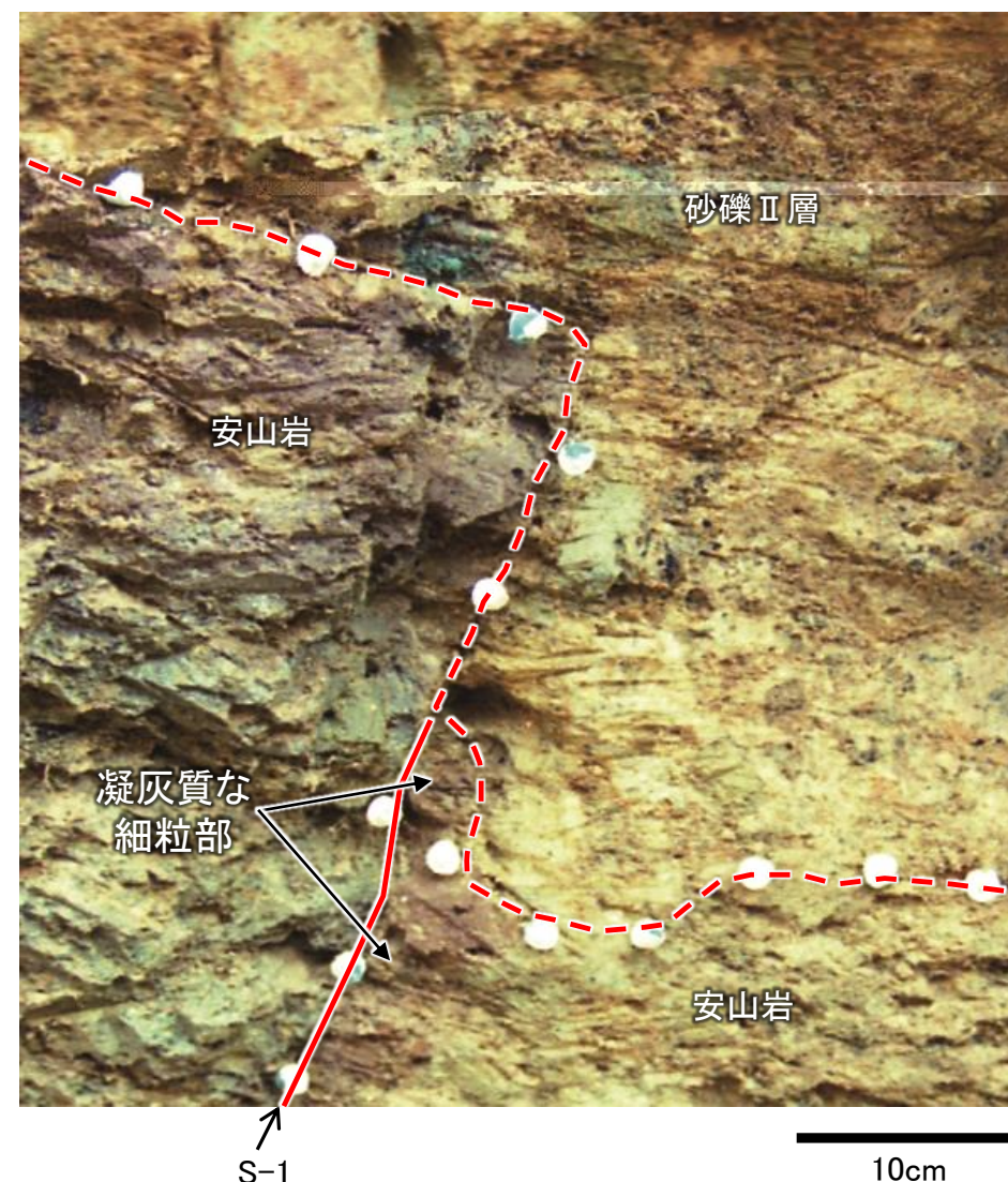
旧Aトレンチ南東壁面 シーム付近拡大写真 (シーム及び岩盤/堆積物境界を加筆)
