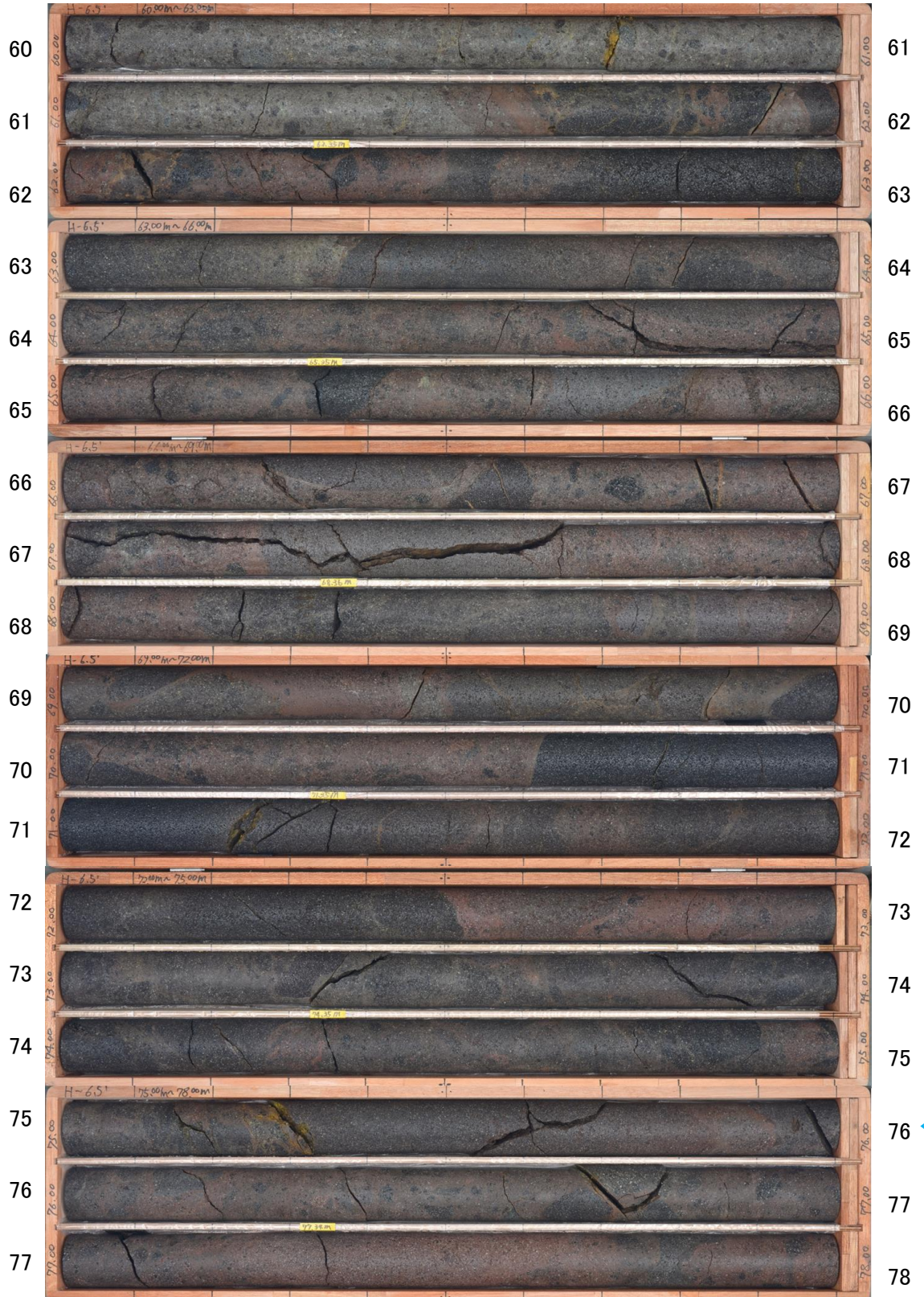
深度(m) H-6.5' 孔(孔口標高11.02m, 掘進長180.00m, 傾斜45°) 深度(m)
