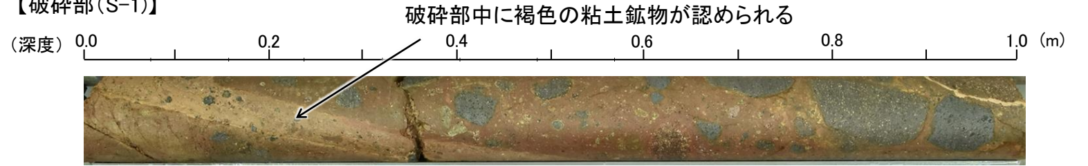
破碎部中に粘土鉱物が認められる事例 (試料e. 岩盤調査坑 No.27孔 深度0.25m付近)
