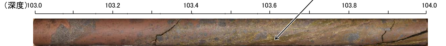
破碎部中に白色鉱物(オパールCT)の鉱物脈が認められる事例 (試料viii. H-1.1孔 深度103.62m付近)
