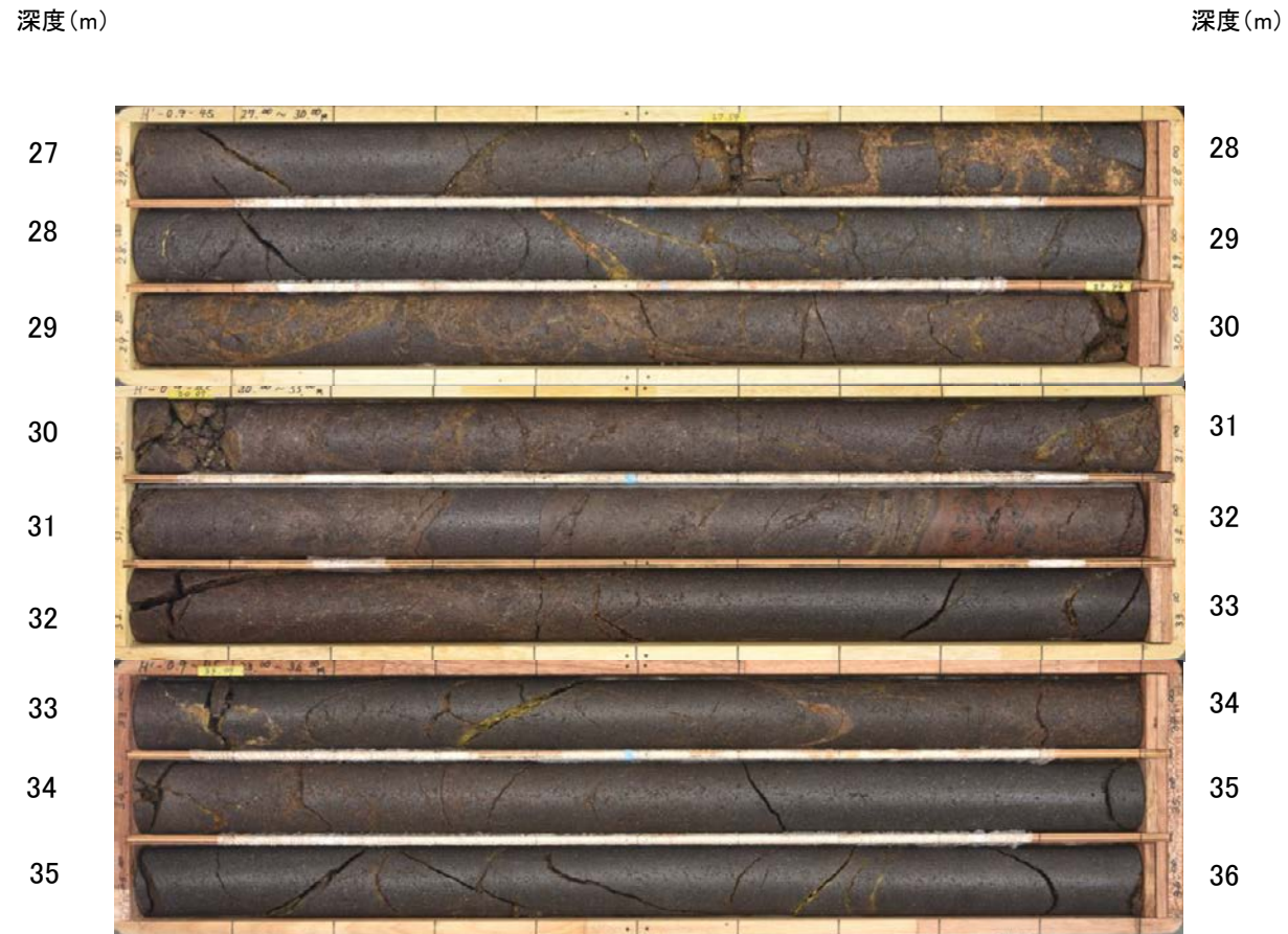
H'-0.9-45孔(掘進長40.00m, 傾斜45°)
