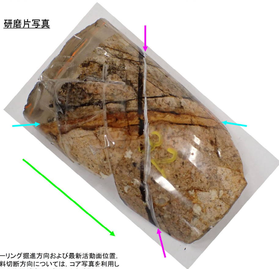
ボーリングの掘進方向、最新活動面、試料切断面の関係を3次的に示した図
