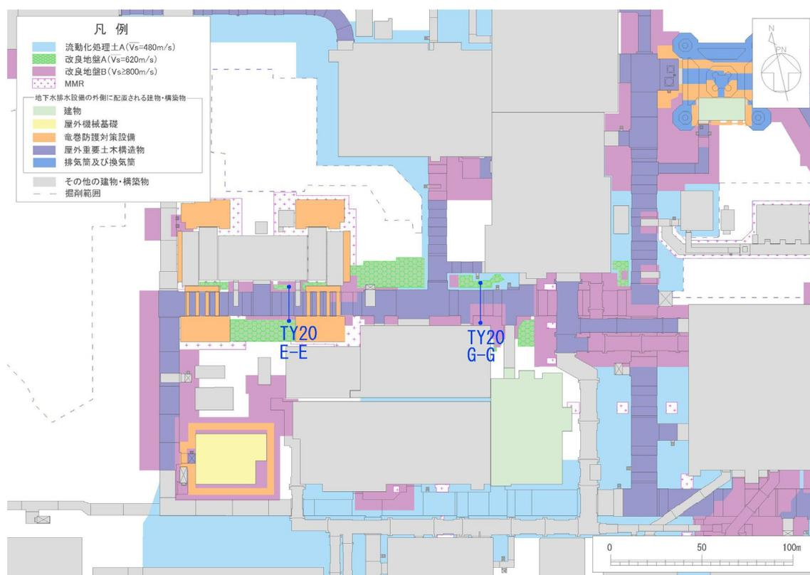
第 2.2.2-1 図 (1) 改良地盤の平面図 (TY20)
