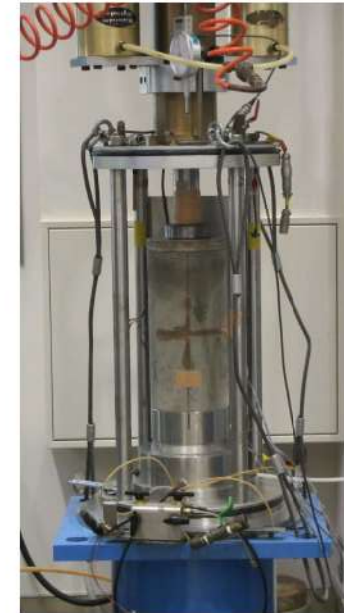
一軸圧縮試験の状況
