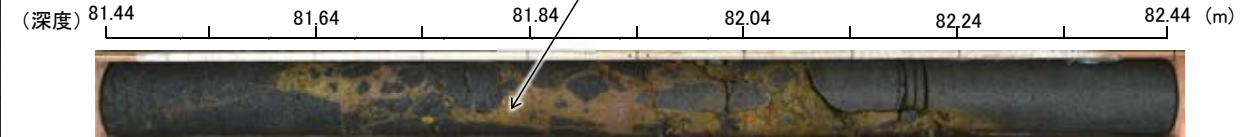
母岩中の割れ目に沿って粘土鉱物脈が認められる事例 (試料R, H-6.5-2孔 深度81.80m付近)
