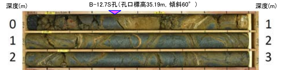
コア写真(B-12.7S孔 深度0~3m) 岩盤(深度0.40m~)の上位には盛土のみ認められる
