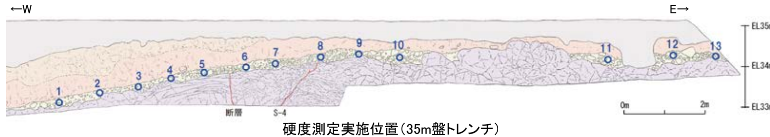
硬度測定実施位置(35m盤法面)
