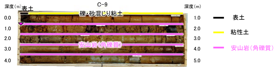
コア写真(深度0~5m) ▼ 礫・砂混じり粘土と安山岩(角礫質)の境界 (EL20.94m)
