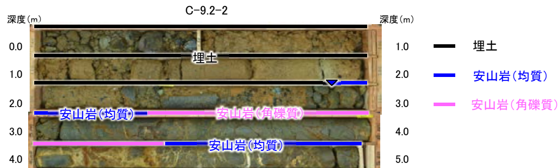
コア写真(深度0~5m) ▼ 埋土と安山岩(均質)の境界 (EL19.32m)
