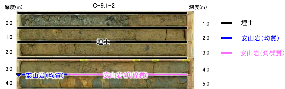
コア写真(深度0~5m) ▼ 埋土と安山岩(均質)の境界 (EL19.36m)
