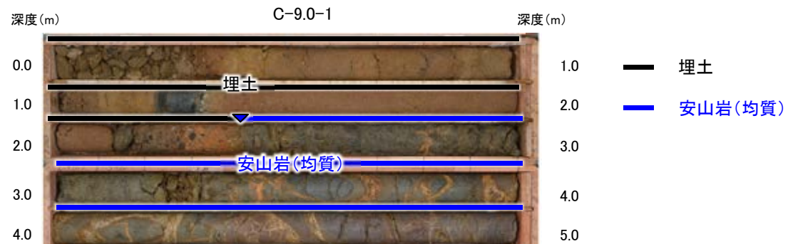
コア写真(深度0~5m) ▼ 埋土と安山岩(均質)の境界 (EL19.84m)
