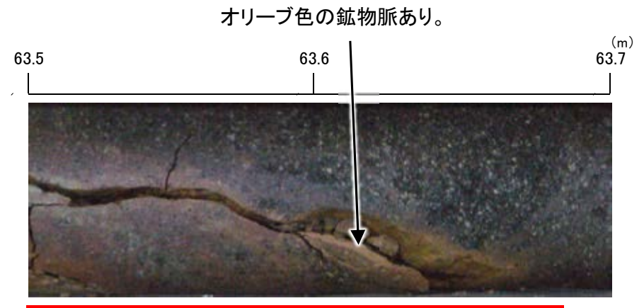
拡大写真(M-12.5孔 63.5～63.7m)
