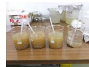
ビーカーを用いた水簸の例
