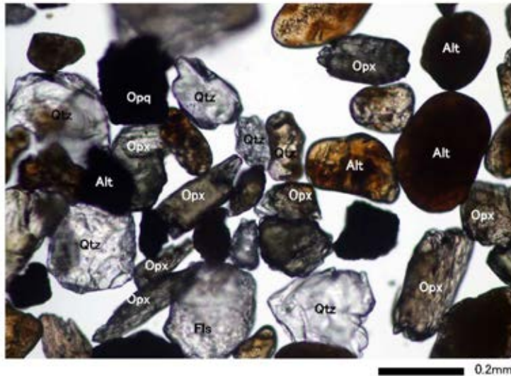
実体顕微鏡写真 (No.1トレンチ)
