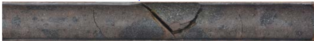
コア写真(H-6.5' 孔 深度76.4~77.0m) 右はBHTV画像
