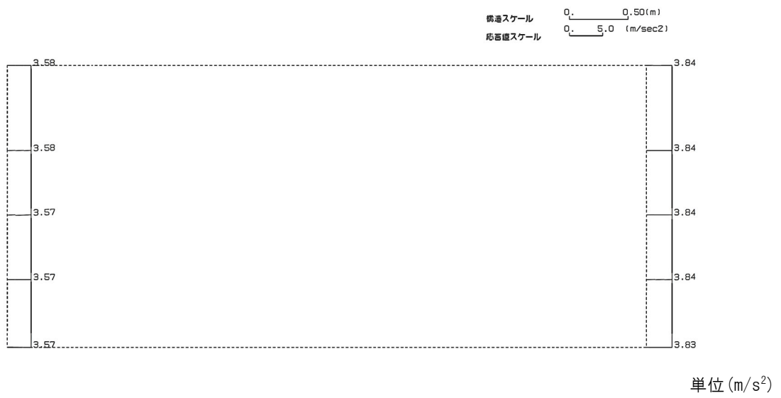
第 4-4 図 h-h 断面の最大加速度分布図 (Ss-C4(NS)) (12/13)
