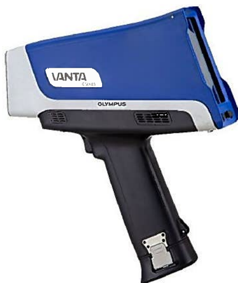
図 4. 1. 4-2 表面塩分量測定器 (ポータブル型蛍光X線分析計)
