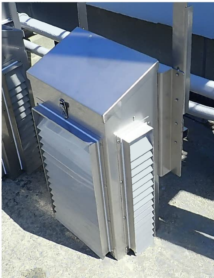
図 4. 1. 4-1 飛来塩分捕集器 (ドライガーゼ法)
