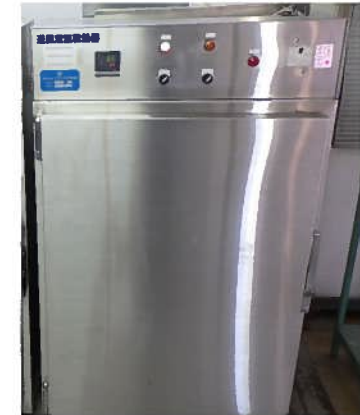
遮蔽能力の点検状況 (コアサンプルの乾燥状況)
