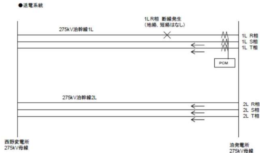
第 3.1 図 送電線保護装置による検知
