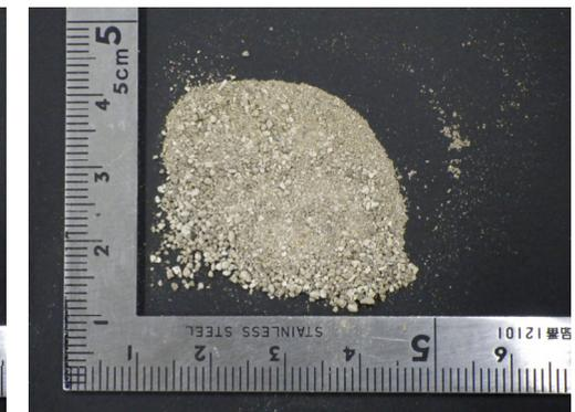
採取試料(粉碎後, 深度6.55~6.60m)
