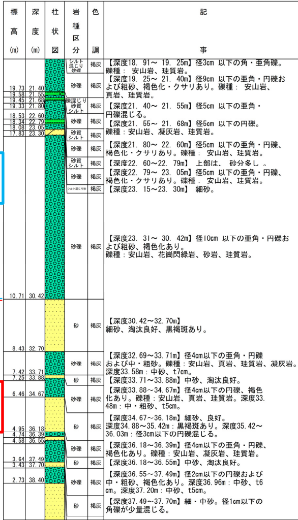
ボーリング柱状図(深度20~40m)
