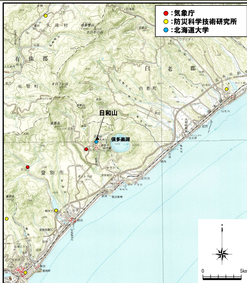
倶多楽・登別火山群周辺の地震計位置図 (気象庁編(2013)「日本活火山総覧(第4版)」に基づき作成)
