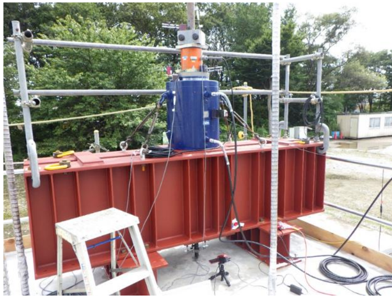
図 3.3-8 模型実験における荷重載荷装置
