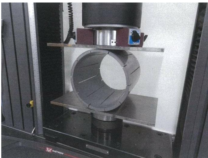
図 2-2 偏平試験の状況写真
