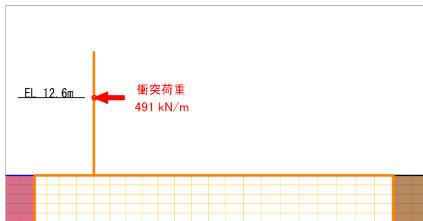
図 3.4.1-1 漂流物対策工における衝突荷重作用図
