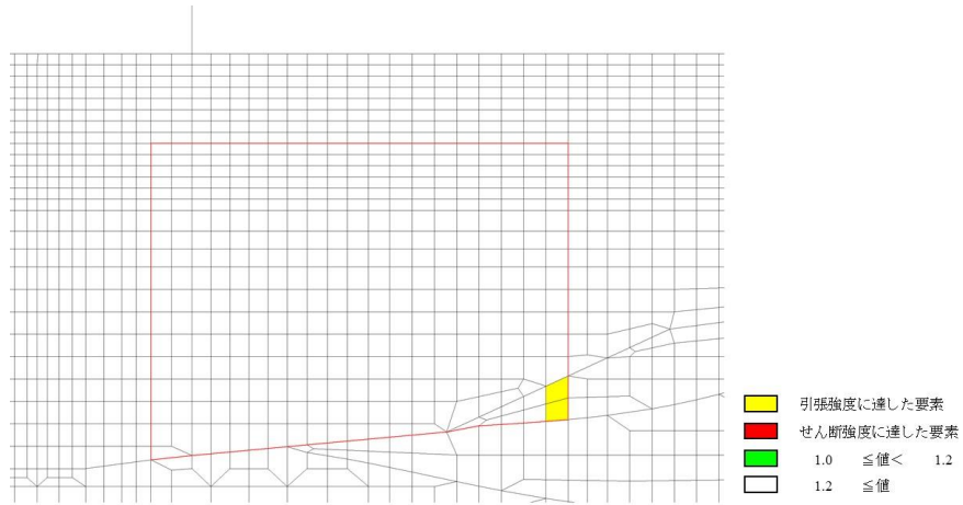
図 6.3-6 (16) MMR の引張応力最大時刻の局所安全係数 (S s - D (--) , 解析ケース③, t=14.59s)
