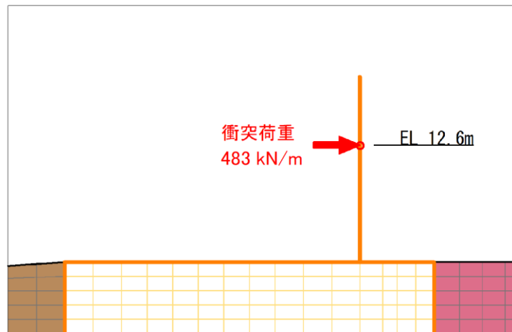
図 3.4.1-1 漂流物対策工における衝突荷重作用図
