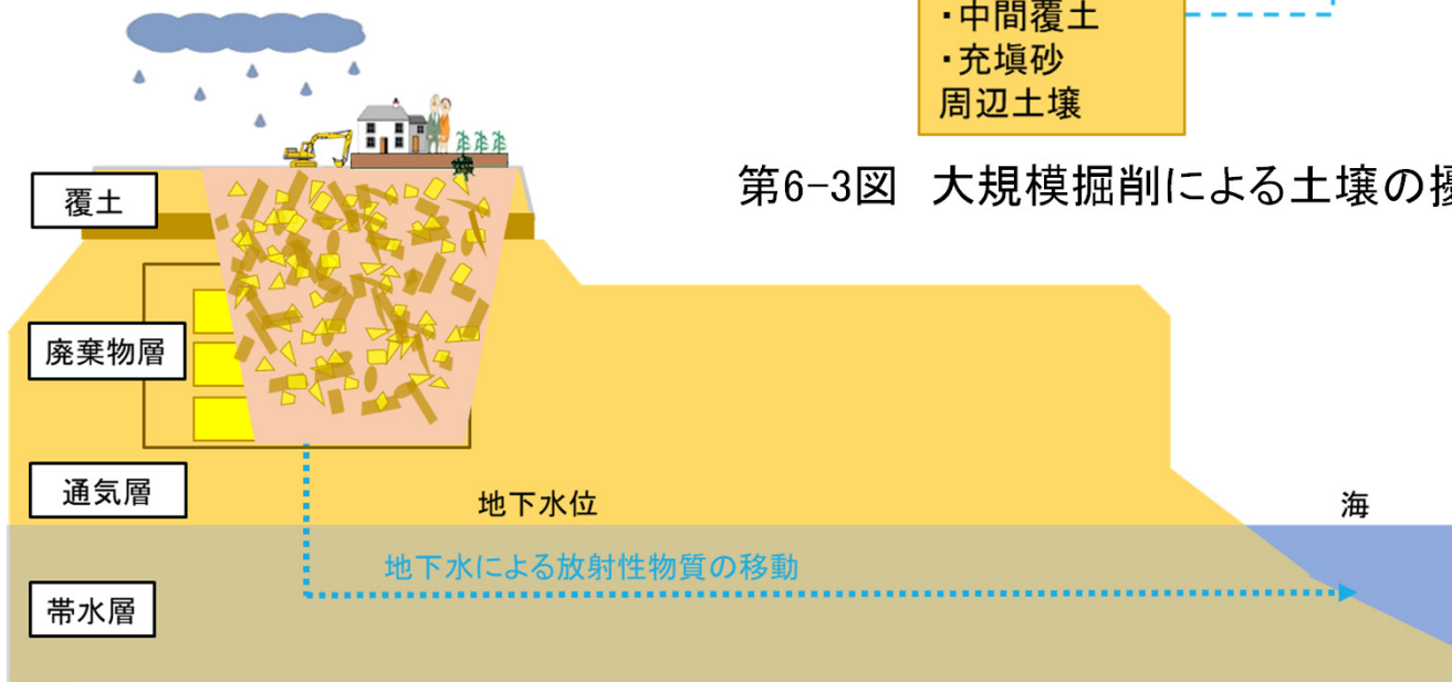
第6-4図 大規模掘削による土壌の擾乱の概念図
