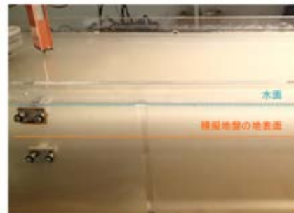
図-4 土槽を浸水させることで水中の未固結堆積物を模擬
