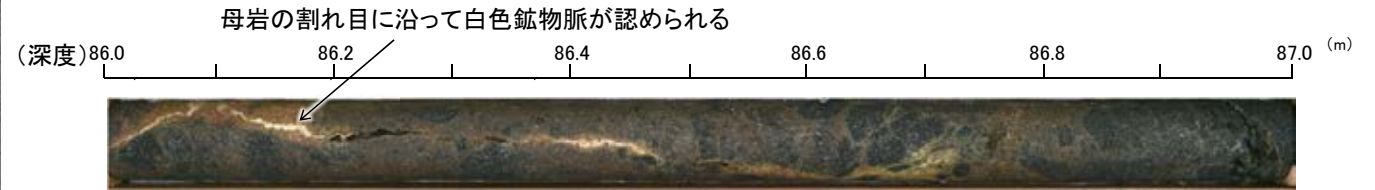
母岩中の割れ目に沿って白色鉱物(フィリップサイト)の鉱物脈が認められる事例 (試料II. J-10.8SW-1孔 深度86.18m付近)
