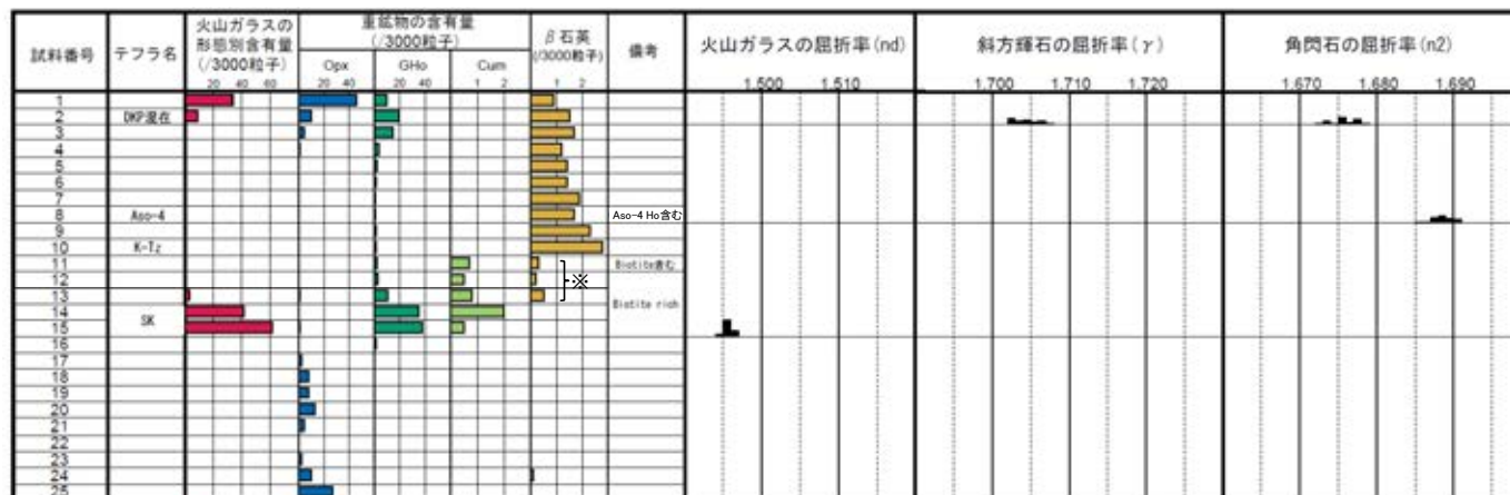
火山灰確認用ボーリング 火山灰分析結果
