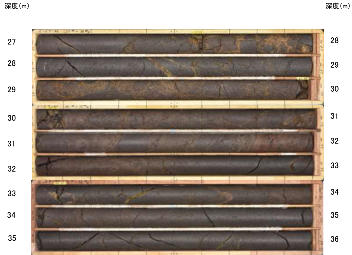
H' -0.9-45孔(掘進長40.00m, 傾斜45° )
