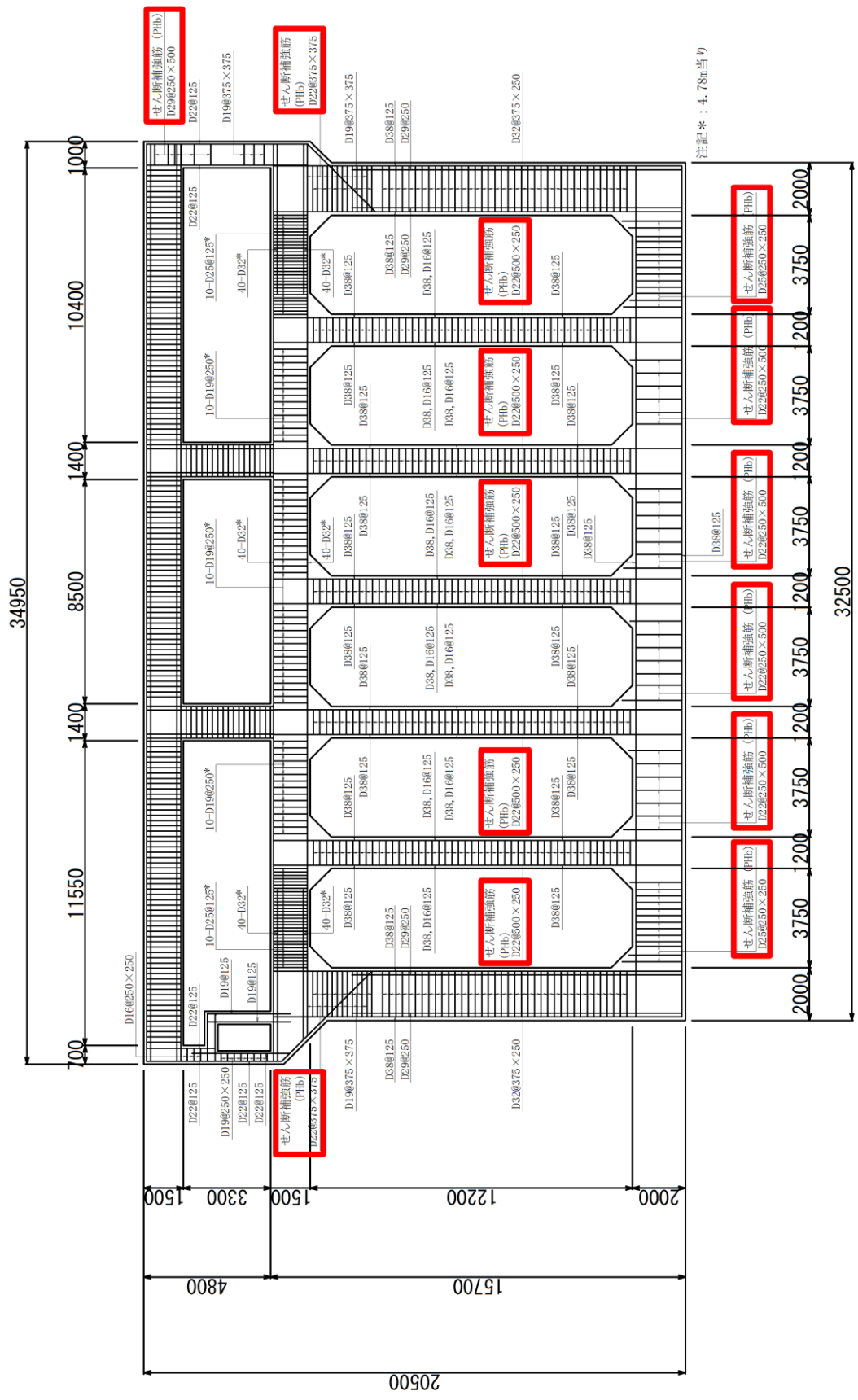
图 2-8 取水槽 概略配筋图 (A-A 断面)
