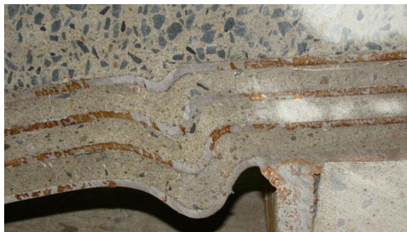
図2 切断面拡大図（圧縮縁）
