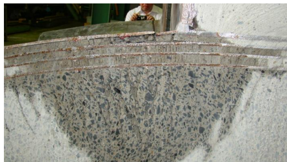
図3 切断面拡大図（引張縁）
