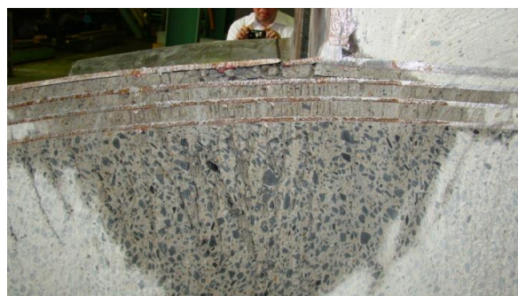
図3 切断面拡大図（引張縁）
