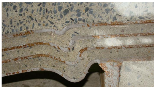
図2 切断面拡大図（圧縮縁）
