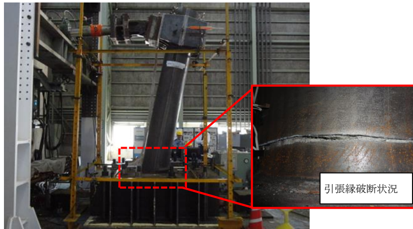
図 2-10 水平載荷実験終了時の状況（実験ケース①-2）
