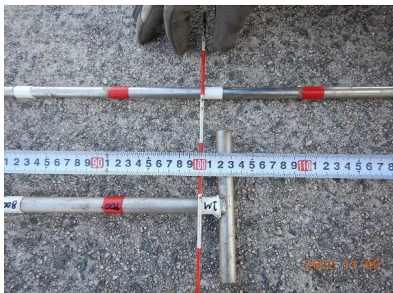
(c) 使用鉄筋棒延長確認
