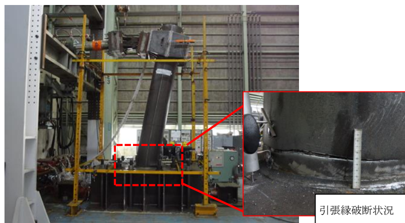
図 2-13 水平载荷実験終了時の状況（実験ケース②）
