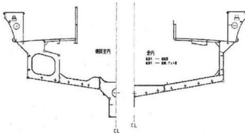
図-2.2 アルミ合金漁船の中央断面図
