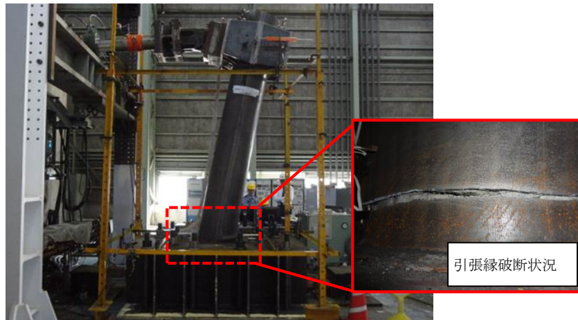
図 2.2-10 水平載荷実験終了時の状況（実験ケース①-2）
